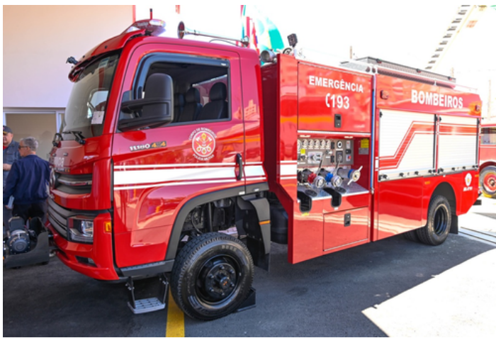
Foto: Caminhão autotanque de combate à incêndios florestais - PMC (2025)
